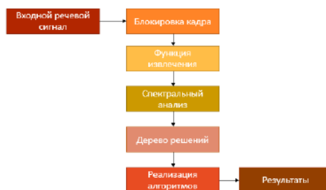
Рис. 1. Общие шаги для системы распознавания речи (SRS)
