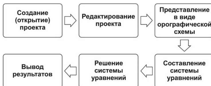
Рисунок 4. Блок-схема программы моделирования каскада водохранилищ
