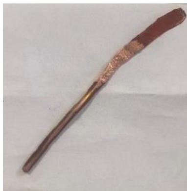
Şəkil 2. 9 V gərginlikdə 10 dəqiqəlik elektroliz prosesindən sonra mis (Cu) katodun səthində yaranan çökiyyə və oksidləşmə izləri
