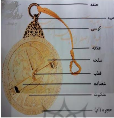
شکل (۱) طرح کلی از اسطرلاب و اجزای تشکیل دهنده آن
