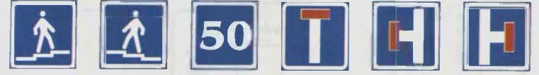
5.17.3 Yerüstü piyada keçidi 5.17.4 Yerüstü piyada keçidi 5.18 Tövsiyyə edilən sürət 5.19.1 Dalan 5.19.2 Dalan 5.19.3 Dalan
