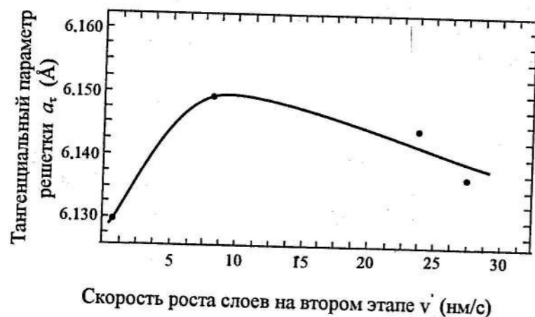
Рис.4 Зависимость тангенциального параметра кристаллической решетки эпитаксиальных слоев PbSe при толщинах 100-200 нм от скорости роста на втором этапе
