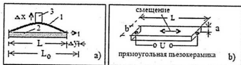
Рис. 2. Пьезокерамический привод с плоскими подпружиненными пластинами
