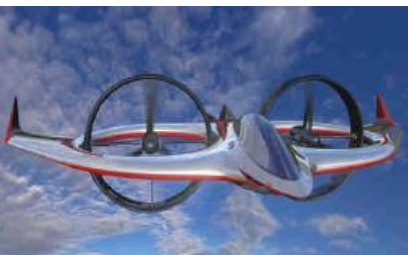
Şək. 1. "Project Zero" elektrik konvertoplanının üfüqi uçuş zamanı mühərriklərin vəziyyəti
