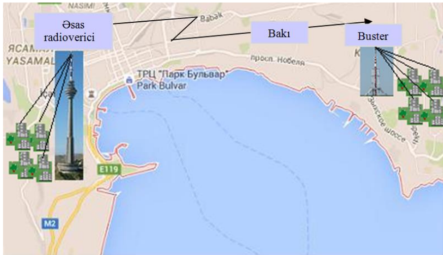
Şəkil 1. Kabel TV-nin paylayıcı şəbəkəsində əsas radiovericinin və retranslyatorun yerləşməsi
