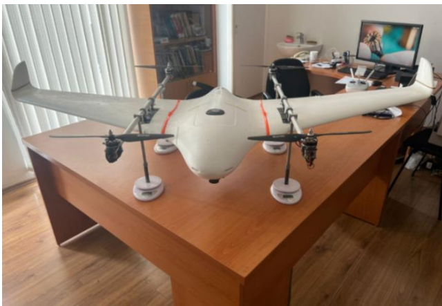
Şəkil 4. Konvertoplan tipli PUA-nın AM-nin təyin olunması məqsədi ilə laboratoriyada hazırlanmış işçi yer
