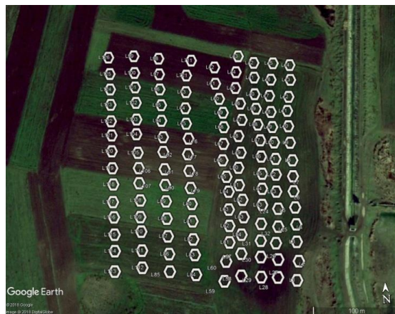
Şəkil 2. Alxantəpə sahəsində tədqiqat profilləri üzrə nivelirləmə və qravimetrik ölçü nöqtələrinin yerləşmə sxemi
