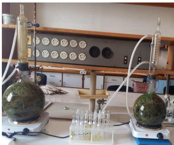
Şəkil 1. Su buxarında distillə üsulu ilə rozmarin bitkisindən efir yağının alınması
