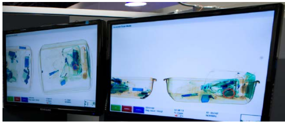
Şəkil 3.7. Baqajın üfqi və şaquli istiqamətlərdə skanerlənmiş təsvirləri
