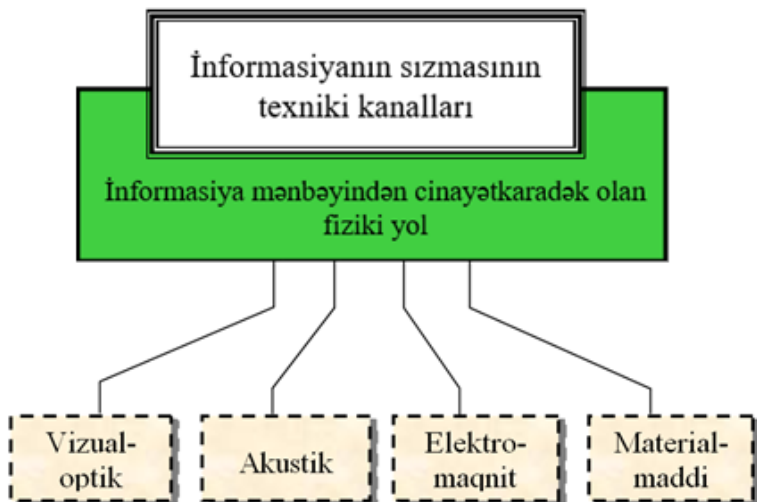
Şəkil 6.3. Sızma kanalları
