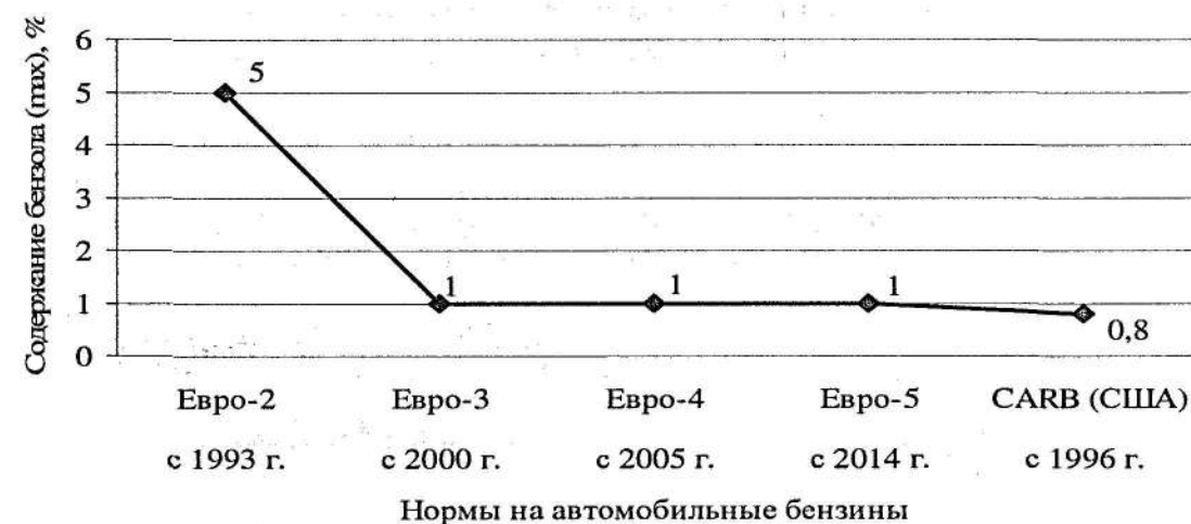
Рис. 1 - Максимально допустимое содержание бензола в товарных автомобильных бензинах
