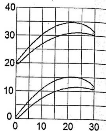
Рис. 4. Решетка профилей лопаток турбины.
