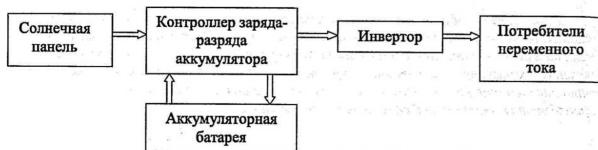
Рис. 1. Структурная схема автономной фотоэлектрической установки
