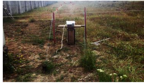
Şək. 3. Diferensial tutum duyğacının həssas elementlərinin: a - yerləşmə sxemi, b - ərazidə quraşdırılmış görünüşü
