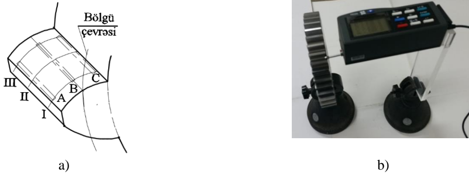
Şəkil 3. Dişdə evolvent profilin səthin nahamarlığının ölçülməsi: ölçmə məntəqələri (a) və ölçmə (b)
